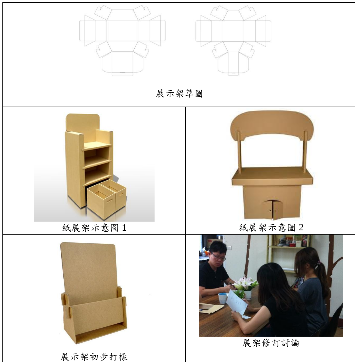
圖 57 綠色設計模組化展架結構設計輔導輔導照片
