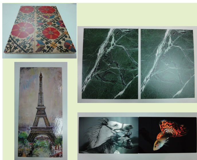
● 圖 1 宣城科技透過 CRUSE 高階掃描儀進行圖像高傳真複製，同時結合特殊紙材及藝術微噴等製作技術，將圖像運用於不同材質中 (材質左上至右下依序為：木板、美耐板、磁磚及鋁板)
