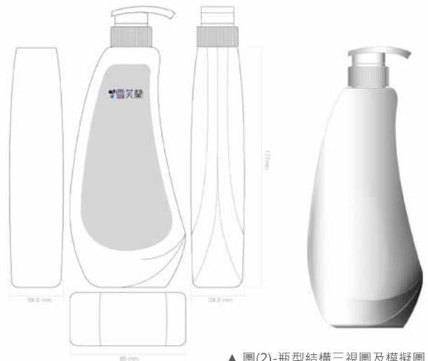
▲圖(2)-瓶型結構三視圖及模擬圖
